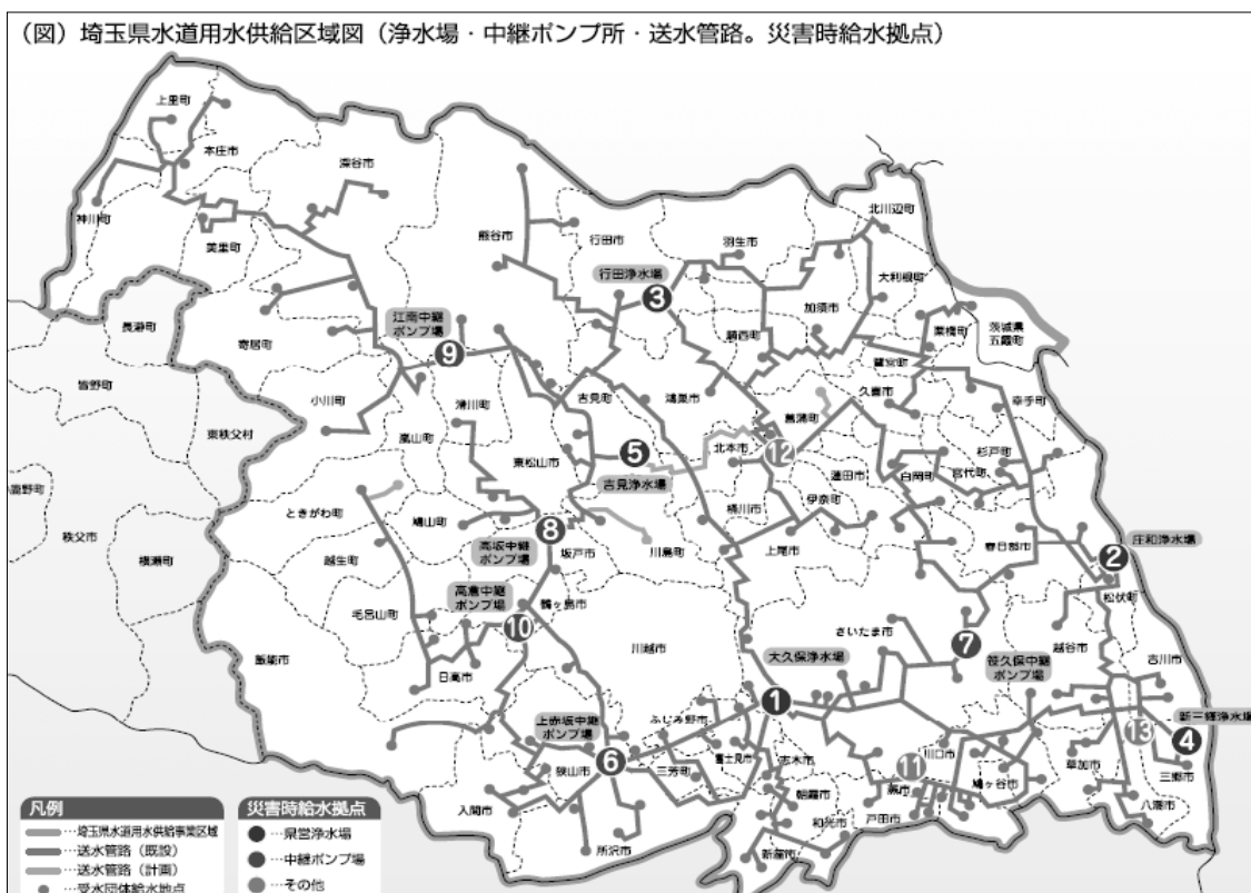
県営水道の応急給水拠点
