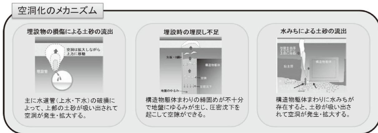
図－1 空洞発生のメカニズム
