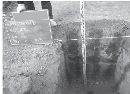
施工厚さ（フェノールフタレイン溶液による反応）
